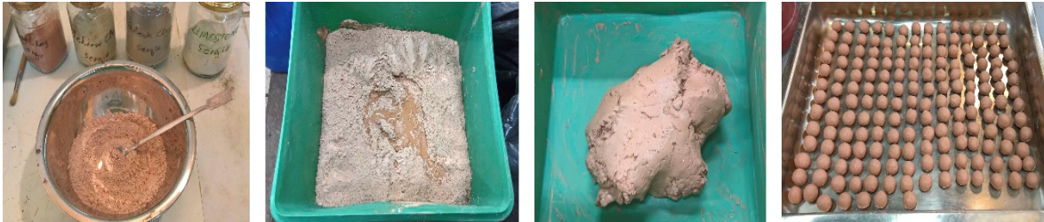
Figura 2. Proceso de fabricación de harina cruda o crudo y de conformación de pellets.
