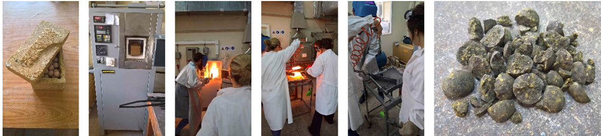
Figura 3. Proceso de clinkerización y enfriamiento del clinker de eco-cemento.
